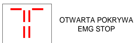
Rys.4 Otwarta pokrywa miodarki, naciśnięto przycisk EMG STOP
